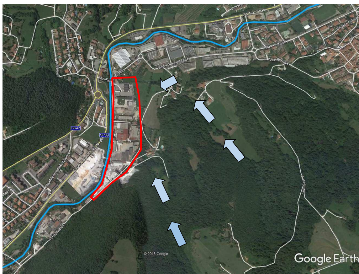
Figura 16 – foto area della località Calvarola con indicazione della direzione di provenienza delle acque di versante
